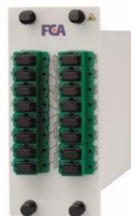
Sprzęgacz mocy w obudowie LGX metalowej
